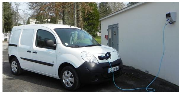
Son autonomie moyenne est de 80 kilomètres en saison froide à 125 km en saison tempérée, pour un temps de recharge d'environ 8 heures sur la borne d'une puissance de 3 kilowatts.
